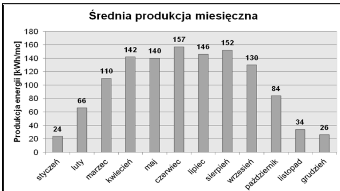
Wykres 11. Produkcja energii elektrycznej przez panele fotowoltaiczne
