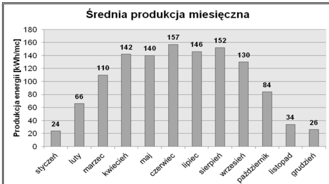
Wykres 11. Produkcja energii elektrycznej przez panele fotowoltaiczne
